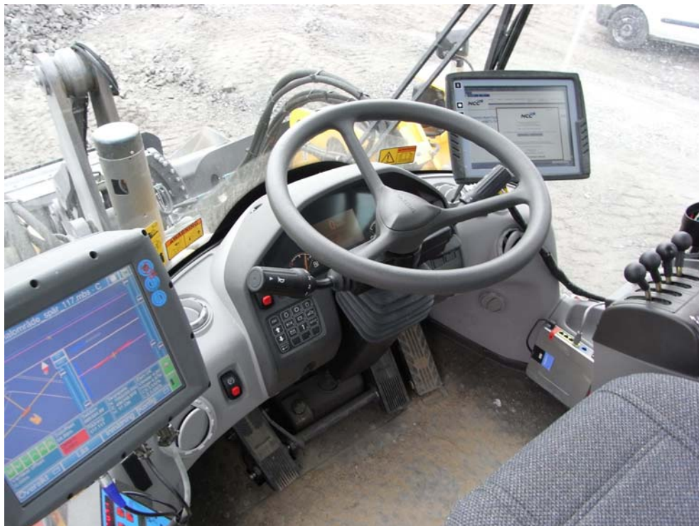
3.2.2 Förarmiljön. För föraren så var hanteringen av data och modeller väsentlig. Maskindatorn GeoRog (tv) var uppkopplad med 3G-routen (th vid golvet) och modelldata skickades direkt från kontoret till maskinen. Han hade även en separat dator uppkopplad mot samma router där han tog emot mail med ritningar och beskrivningar för de olika projekten.
