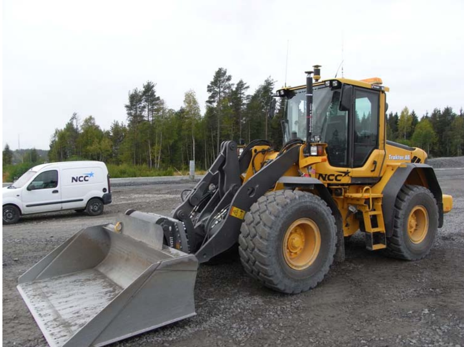
3.2.1 Maskinguidad Hjullastare. Hjullastaren var utrustad med sensorsystem och GNSS mottagare samt maskindator. Maskinen arbetade under tiden på flera olika arbetsplatser vilket gjorde att modelldata hanteringen var omfattande och ändrades ofta.
